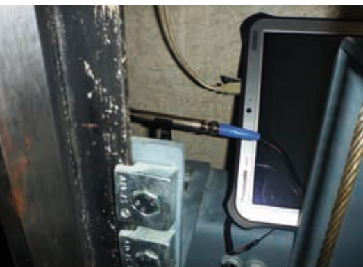
Schallmessung im Schacht Sound measurement in the shaft
