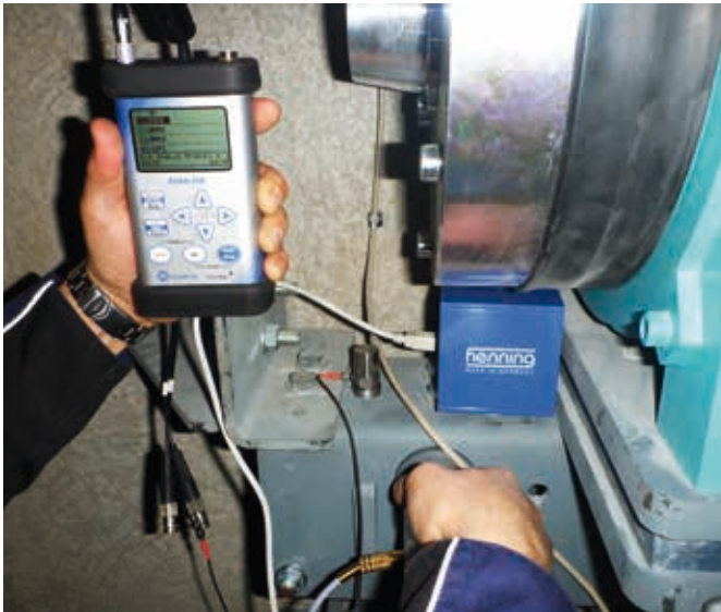
Körperschallmessung auf dem Antriebsrahmen Structure-borne sound measurement on the drive frame
