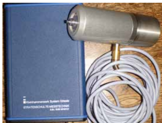
Kleinhammerwerk nach Gösele Gösele small hammer tapping machine system
